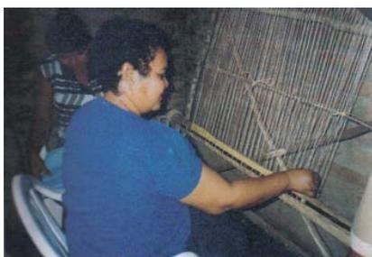
e) Telar: Es vertical y consta de un marco rectangular de palos de madera y dimensiones y proporciones variables de acuerdo al producto. Este rectángulo consta de unos palos verticales constituidos por unas horquetas, en las cuales se le unen en sus cuatro extremos un palo amarrado con alambre para formar el rectángulo.
