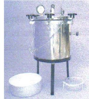
h) Carbonización: Es el efecto contrario del blanqueamiento. En un autoclave se tratan las latillas de guadua con vapor caliente de 150°C durante 30 minutos.
