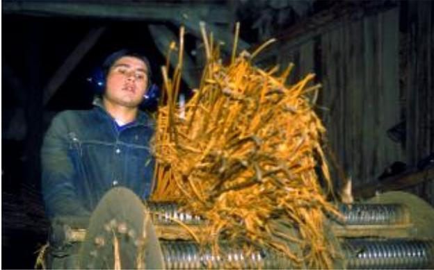
pequeño corte inicial realizado con cuchillo en uno de sus extremos, es guiado hasta el otro extremo. Estas "huiras" son introducidas en agua a temperatura ambiente, para posteriormente, pasarlas por una máquina "descarnadora", que puede ser manual o eléctrica, y cuya función es extraer la médula. Finalmente,
